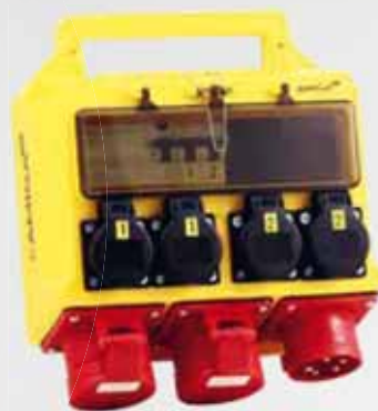
Byggcentral 16 A Intag: 1 st 16 A/400 V. Uttag: 2 st 16 A/400 V vidarematning, 4 st 13 A/230 V avsäkrade 2+2. Art.nr: 15862857
