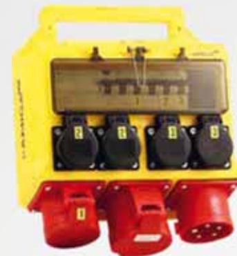
Byggcentral 32 A Intag: 1 st 32 A/400 V. Uttag: 1 st 32 A/400 V vidarematning, 1 st 16 A/400 V avsäkrat, 4 st 16 A/230 V avsäkrade 2+2. Art.nr: 15864580
